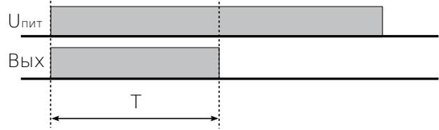
Режим 47. Выключение после отсчета установленного числа импульсов
