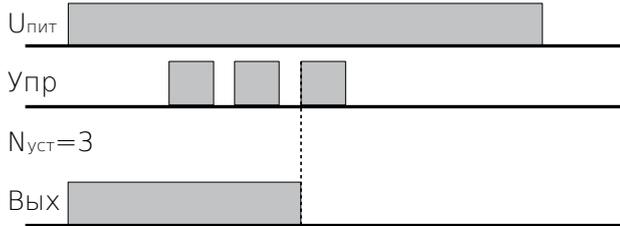
Режим 48. Включение после отсчета установленного числа импульсов
